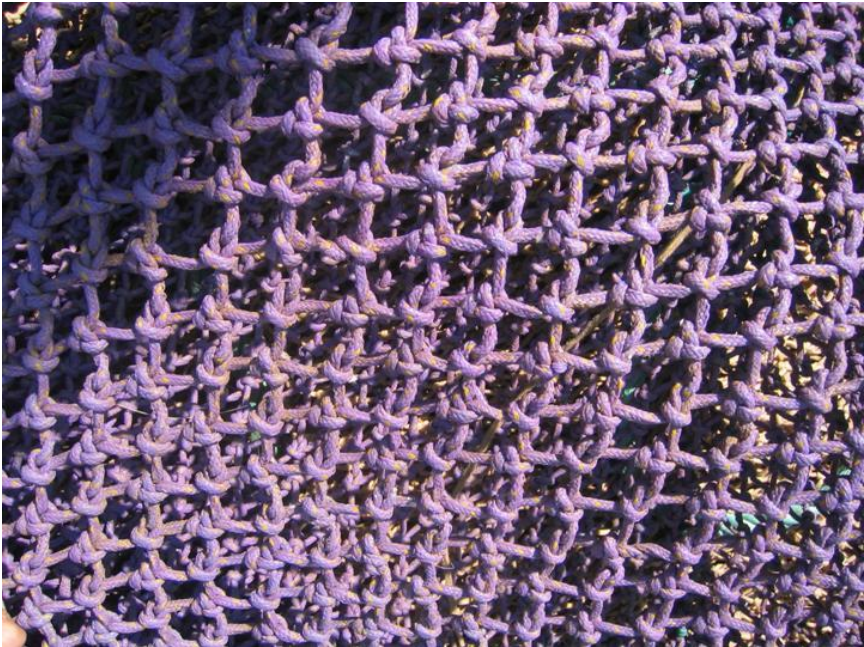
Fig. 3.- Malla cuadrada de 40 mm de luz de malla construida para las experiencias con luz de malla e hilo iguales a los utilizados para malla de rombo.
